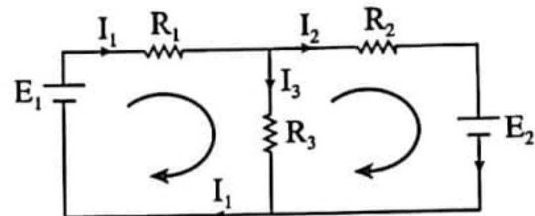
$$\text{প্রথম লুপে: সূত্রানুযায়ী, } I_1 R_1 + I_3 R_3 = E_1 \dots \dots \dots \text{(i)}$$
