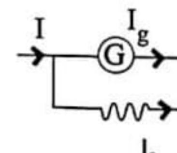
12.  $30\Omega$  অভ্যন্তরীণ রোধের একটি গ্যালভানোমিটার  $500\mu A$  তড়িৎ প্রবাহে পূর্ণ ক্ষেত্র বিক্ষেপ দেয়। এই গ্যালভানোমিটারকে  $2mA$  প্রবাহমাত্রা পরিমাপের উপযোগী করতে কত মানের শান্ট ব্যবহার করতে হবে? [BUET'01-02]
