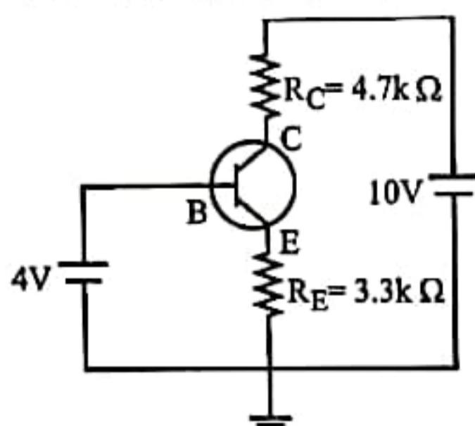
$$\text{সমাধান: } \text{এখানে, } V_C = V_{CE} + I_E R_E$$
